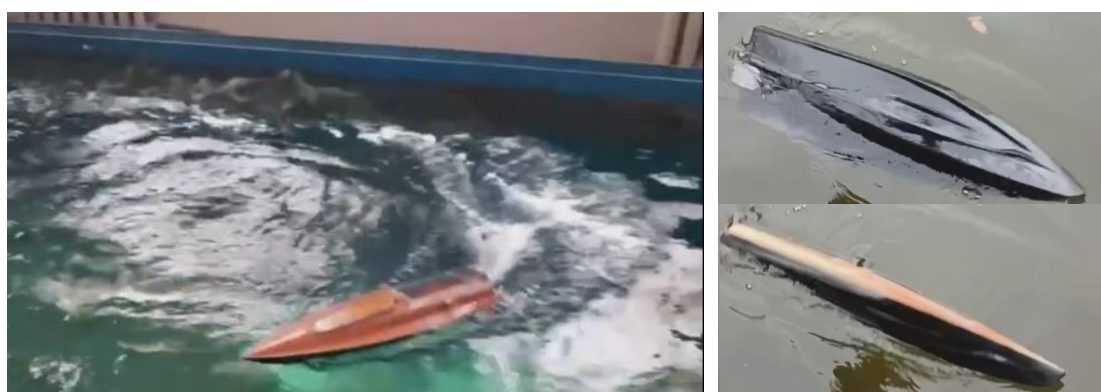
Рис. 2. Испытания модели НБА «Калкан» в опытовом бассейне на маневренность и самоспрявление
