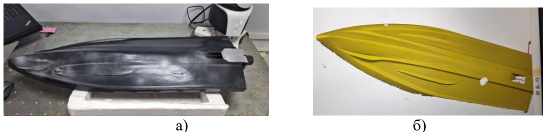
Рис. 2. а) матированная физическая модель лодки; б) скан лодки с обработки
