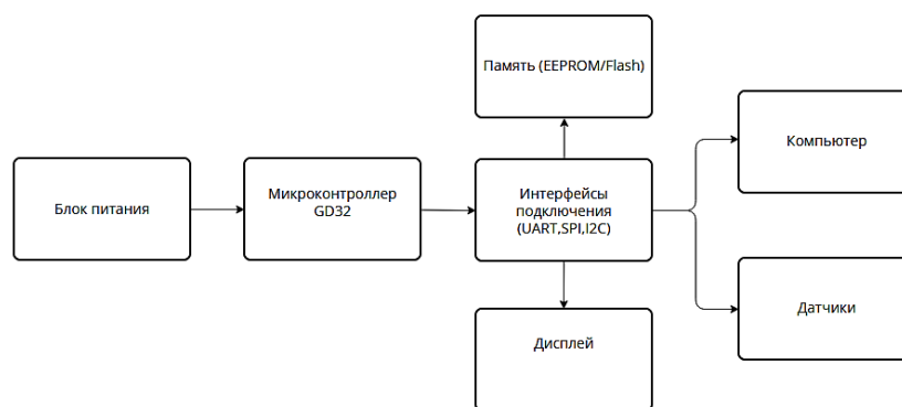
Рис. 1. Блок-схема лабораторного стенда для изучения микроконтроллеров семейства GD32
